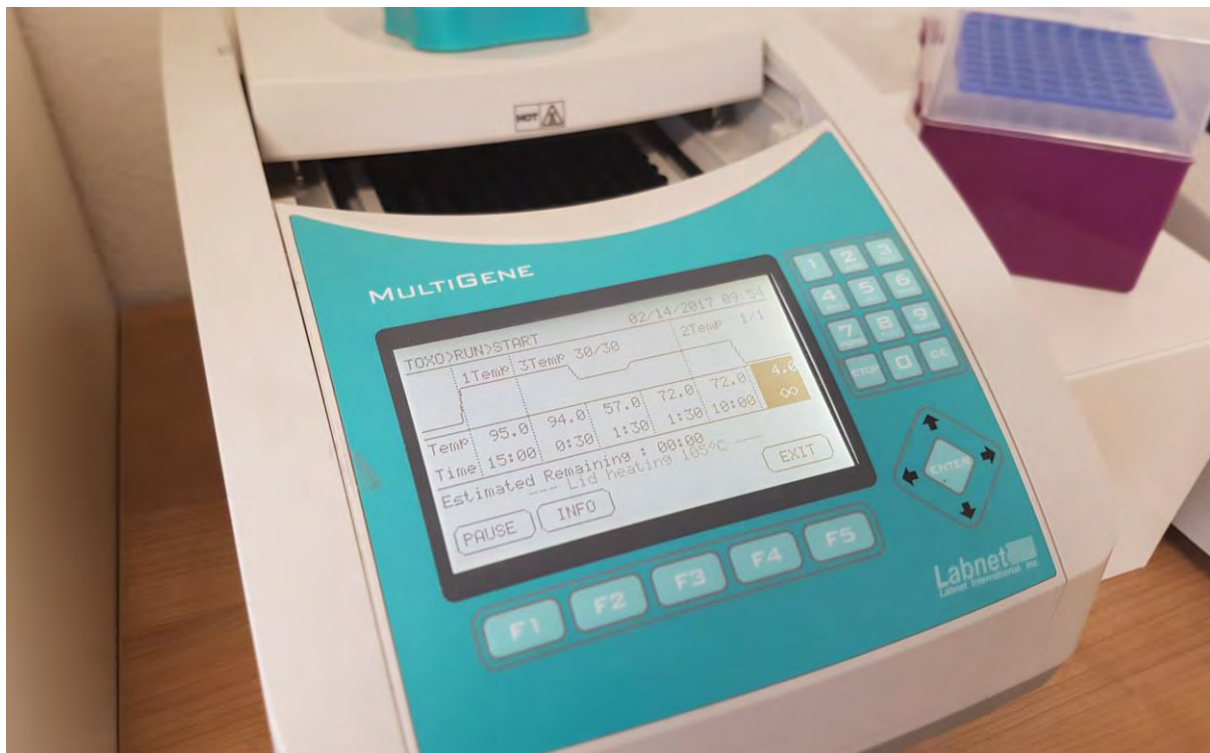
Abbildung 11-1. PCR – Maschine die für die amplifizierung der DNS benutzt wird.
