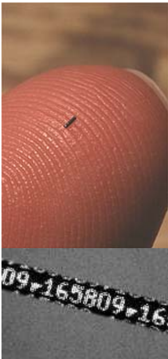
Coded Wire Tag (CWT) im Grössenvergleich und in Vergrösserung
